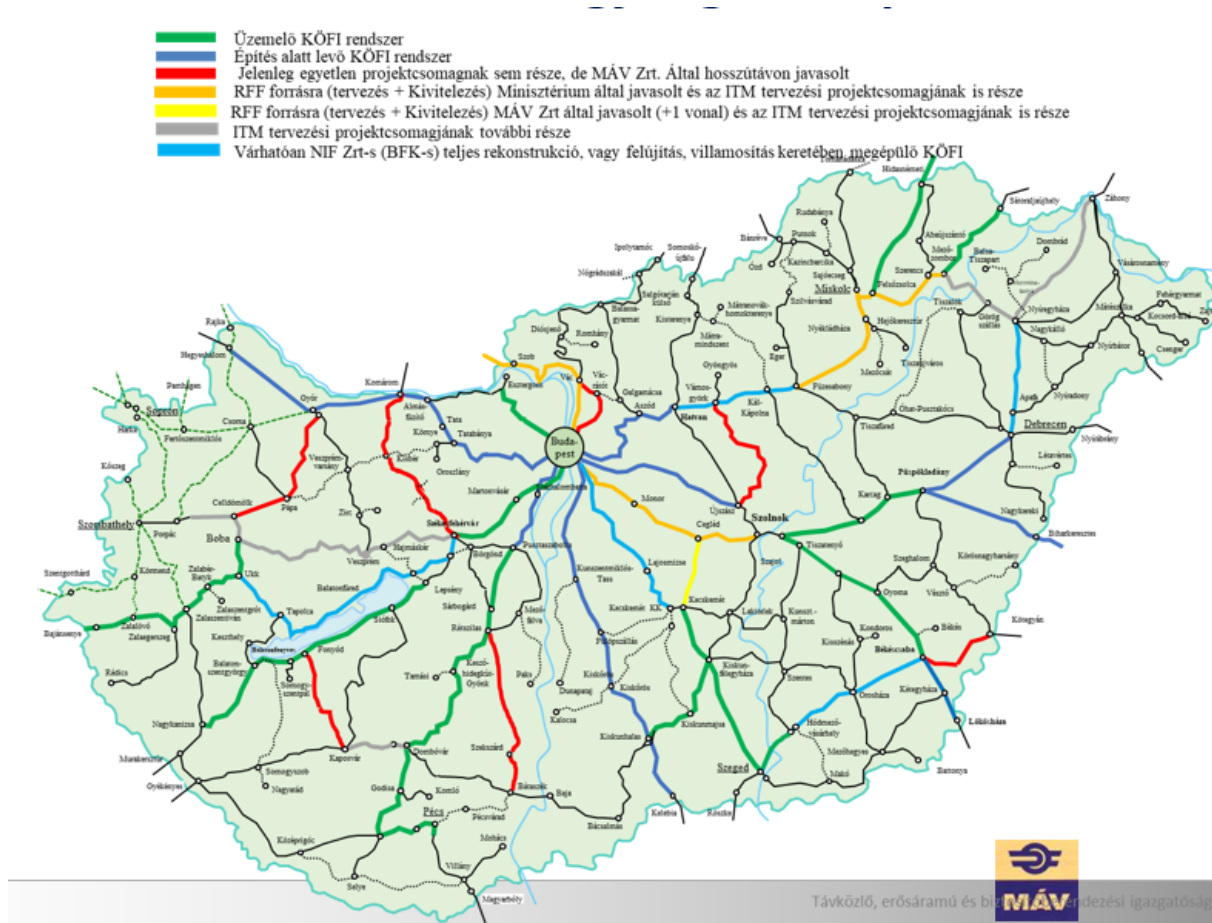
6. ábra: Központi forgalomirányító rendszer kiterjesztése
