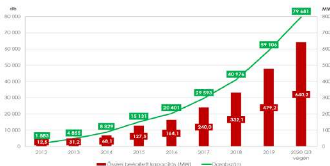
Háztartási Méretű Kiserőművek PV növekedése („HMKE”, beépített teljesítmény <50 kW)
