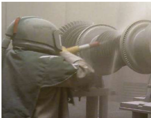
Turbina rotor homokszórás és javítási munkálat
