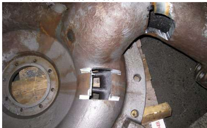
Gőzturbina gőzkamra, amelyet roncsolásos vizsgálatokhoz használnak
