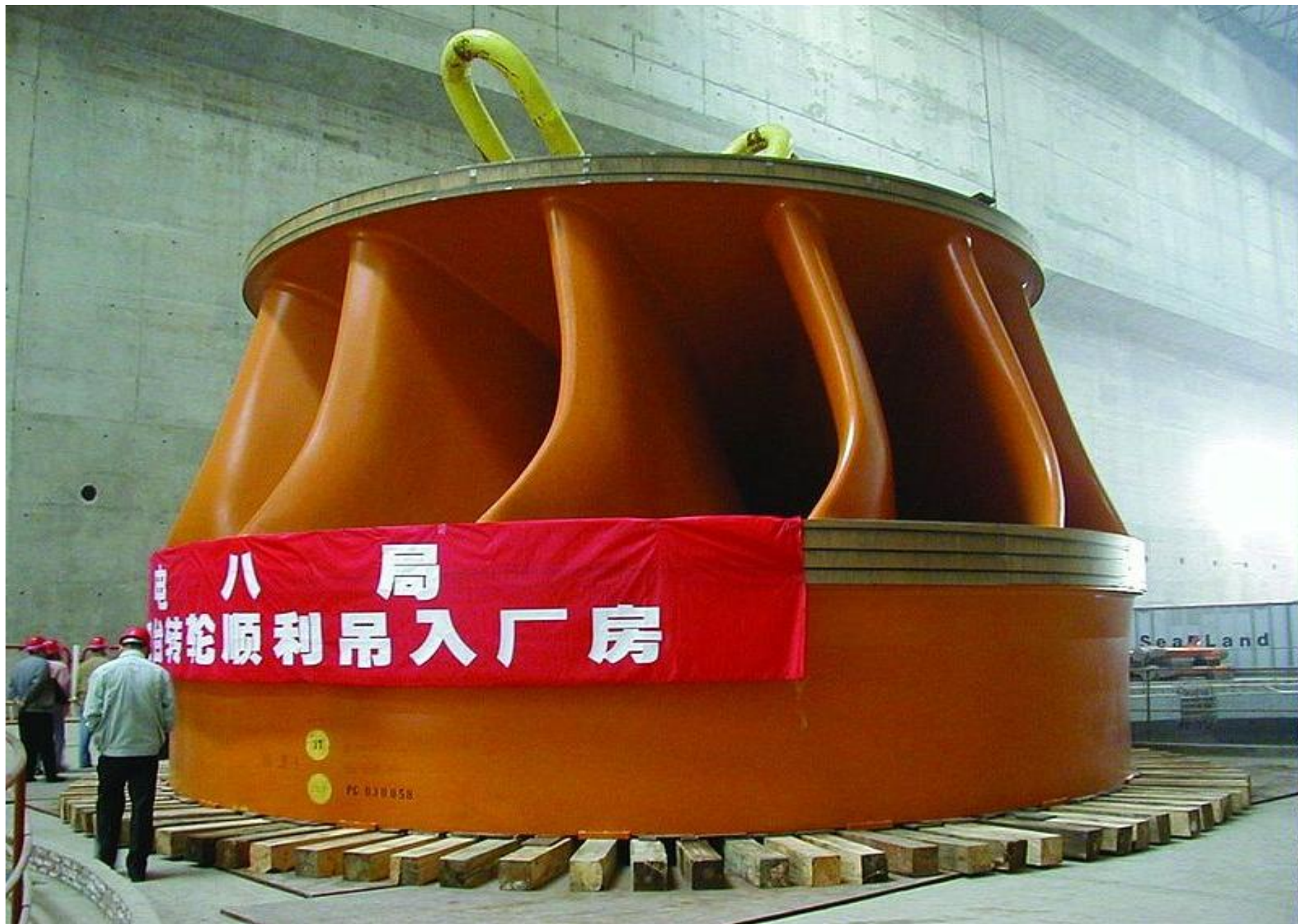
A 700 MW-os Francis-turbina kínai gyártmányú 450 tonnás járókereke
