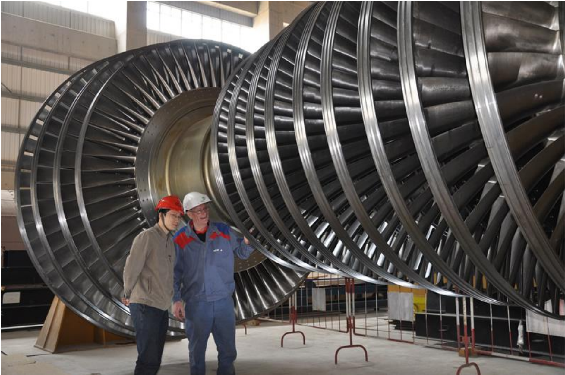
Alstom gyártmányú 1000 MW-os reaktorblokk turbinájának forgórésze
