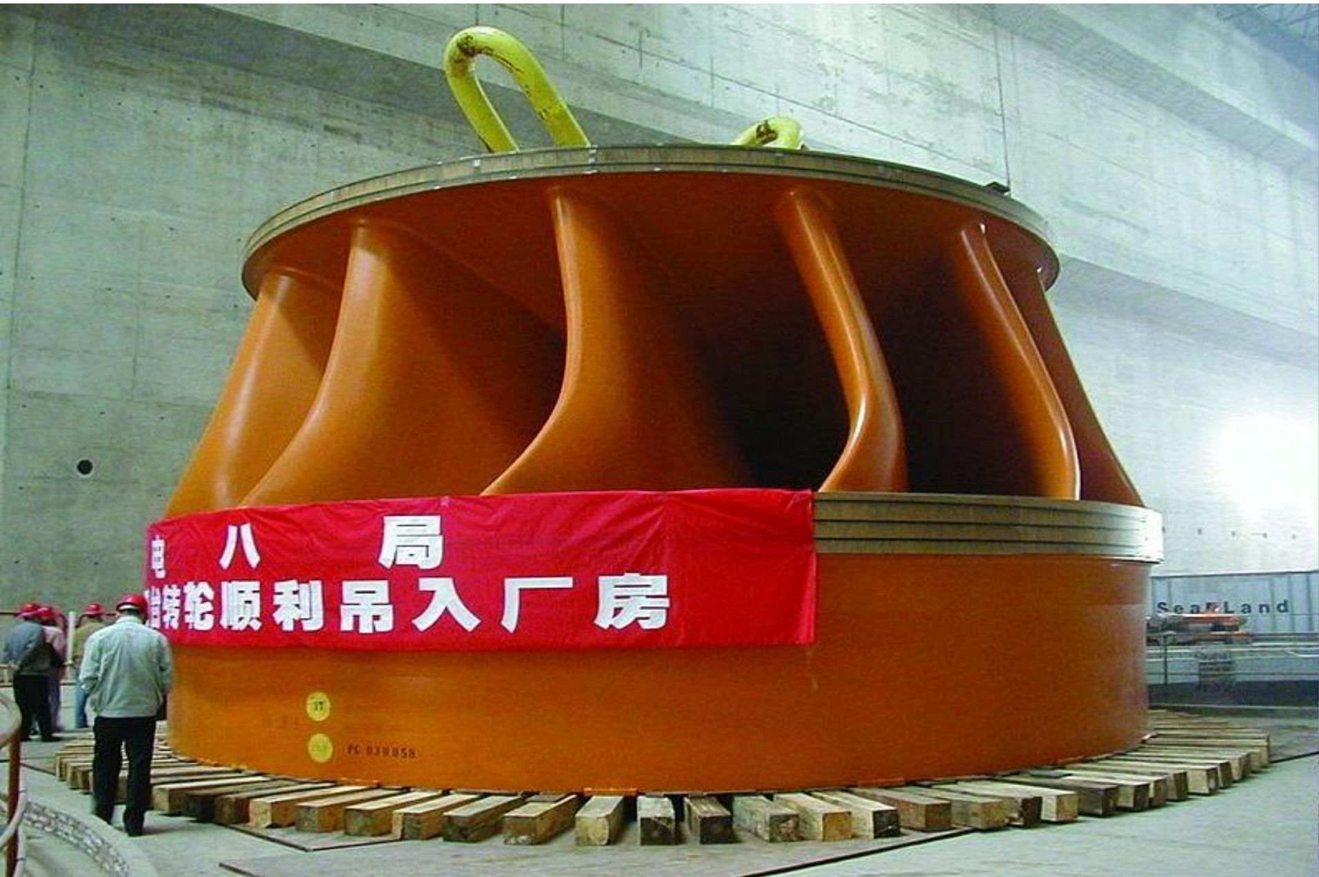
A 700 MW-os Francis turbina 450 tonnás forgórésze
