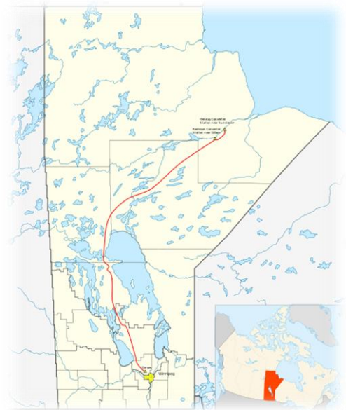
4. ábra: A Nelson River torkolathoz közeli vízerőműveket Winnipeggel összekötő HVDC távvezeték
