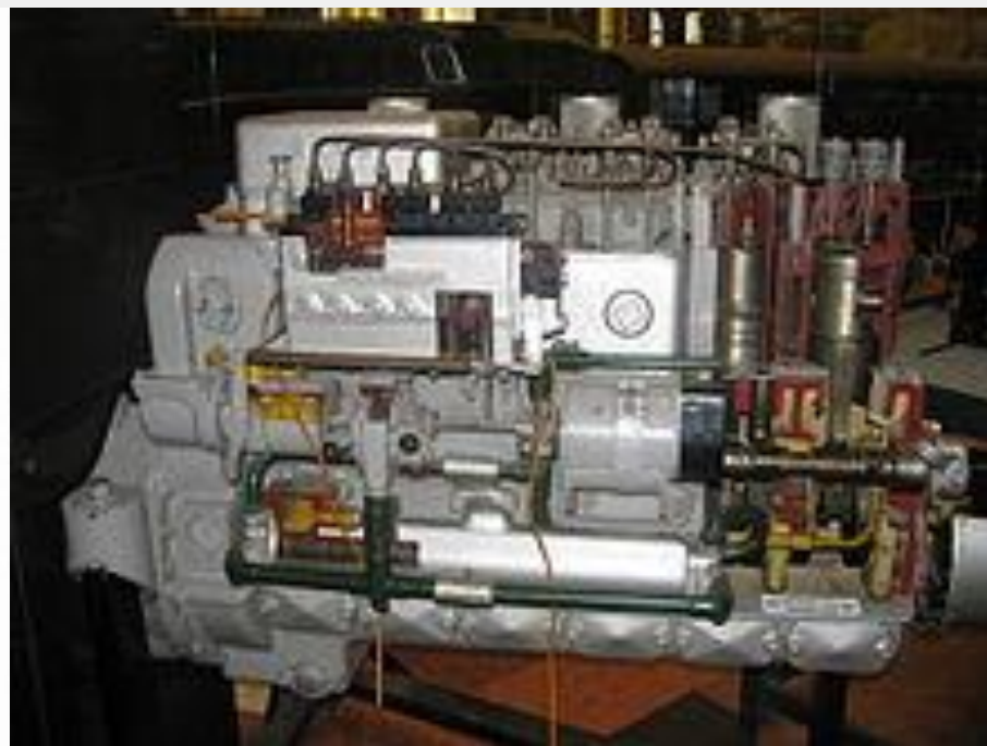
1. ábra. A VI. JaR 135 típusú Jendrassik motor metszete
