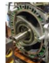
a forgótárcsás belső égésű motor
